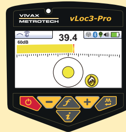
Markerortungs-Ansicht mit Tiefenanzeige auf Knopfdruck
